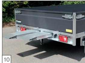
10 **Standard:** avec 2 rampes en aluminium de 250 cm intégrés.
