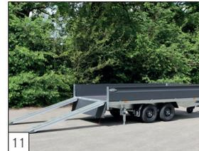
11 **Standard:** avec pack « DE CHARGE » (rampes en aluminium et béquilles).
