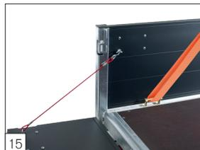
15 **Standard:** système d'arrimage de chargement HAPERT certifié par TÜV: anneaux d'arrimage de 1000 daN, intégrés dans les côtés.
