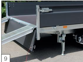
9 **Standard:** profilé en U à l'arrière-côté pour monter les rampes à charger.
